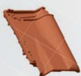
Odvetrávací škridla LQ (vetrací prierez 32,5 cm², cca 16 ks/100 m²)
