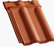
Podhrebňová odvetrávacía škridla (kladie sa v celej rade pod hrebňom, 3,3 ks/m na stranu hrebňa)
