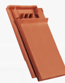
Podhrebeňová odvetrávacía škridla (kladie sa v celej rade pod hrebeňom odvetrania cca 230 cm 2 /bm)
